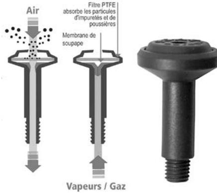
Lors du fonctionnement de l'installation HPLC, la membrane est ouverte. Au repos, la membrane fermée hermétiquement empêche le dégazage de vapeurs nocives.
